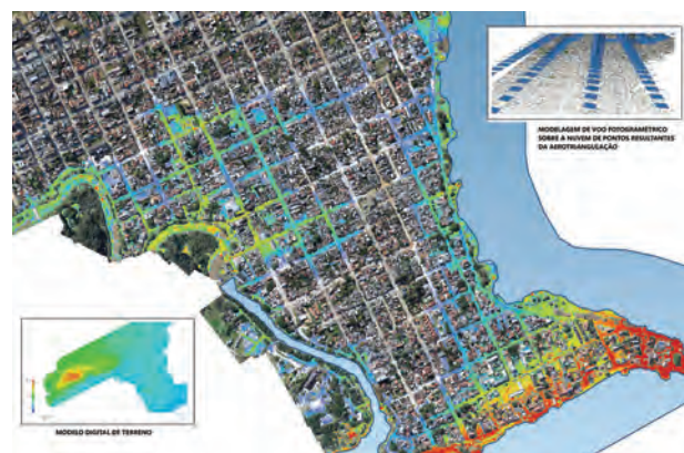
Figura 4. No alto, a modelagem de voo fotogramétrico sobre a nuvem de pontos resultantes da aerotriangulação; abaixo, o Modelo Digital de Terreno (MDT) derivado; e ao centro o ortofotomosaico da área, com resolução final de 5 cm para a cidade de São Lourenço do Sul, obtido pela equipe da FURG.
