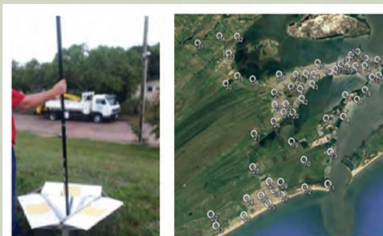
◀ Figura 5. Os refletores laser implantados, e a disposição dos pontos sobre o território de Rio Grande utilizados para composição de um modelo de correção geoidal local.
