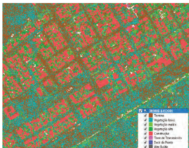
Figura 8. Imagem gerada com os dados da nuvem laser scanner reduzida ao referencial vertical do Serviço Geológico do Brasil (Marégrafo de Imbituba, SC).
