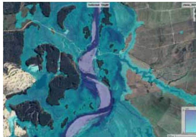
Figura 14. Exemplo de mapeamento da inundação no Rio Santa Maria, na região da localidade de São Simão, a partir de dados levantados em campo e modelagem hidráulica
