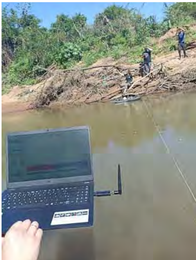
Figura 12. Imagem captada durante a batimetria com ADCP e GNSS
