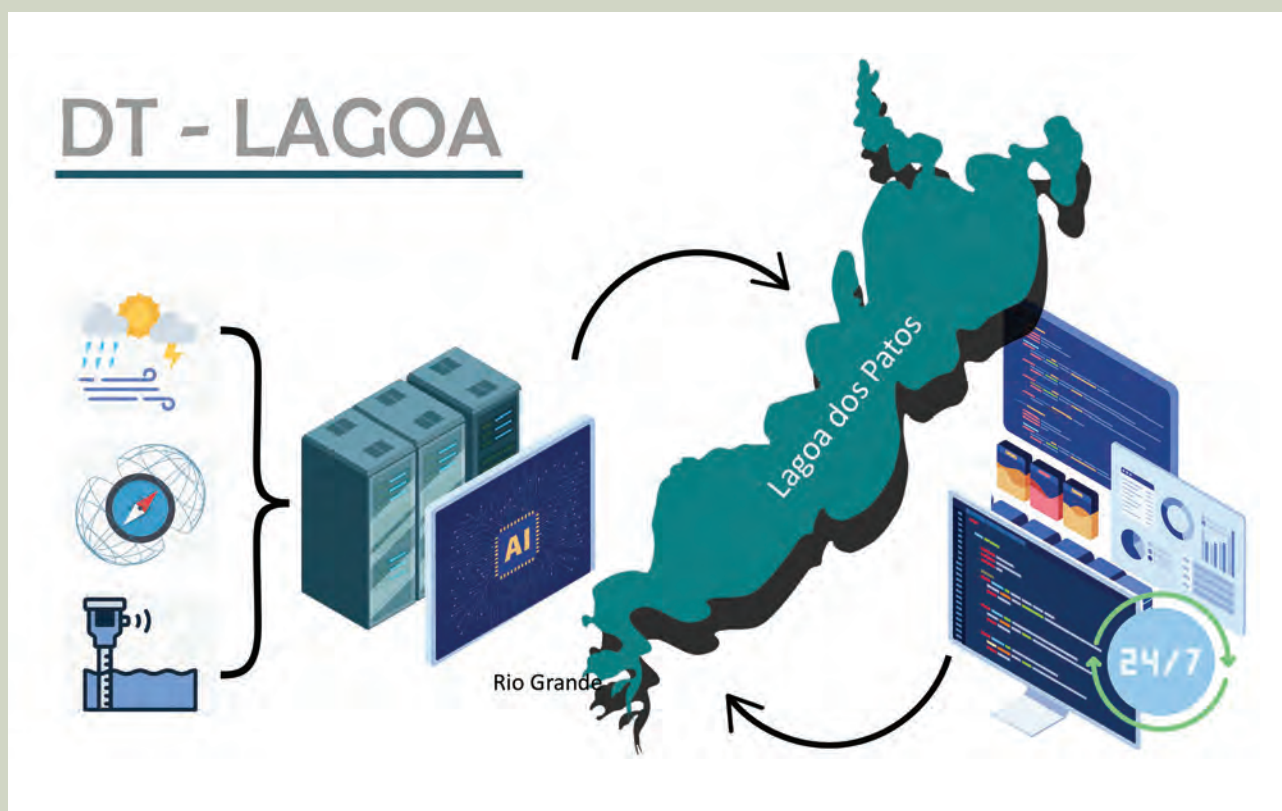
Figura 1. O conceito do Digital Twin Lagoa dos Patos (DT – Lagoa). Dados meteorológicos (precipitação, ventos), geodésicos (do terreno) e oceanográficos (nível) alimentam o ambiente virtual para a adequada observação das condições ambientais em tempo real, e são utilizados para a qualificação dos modelos numéricos (hidrológico e hidrodinâmico) e de modelos computacionais de Inteligência Artificial (modelo de inundação), gerando previsões sobre o comportamento hidrodinâmico da Lagoa dos Patos e os impactos sobre os municípios localizados às suas margens. Essas previsões foram utilizadas para tomada de decisão pelas forças de segurança pública durante o evento de inundação de maio de 2024.
